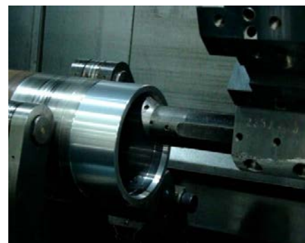
Расточка заготовки, поддержка гидравлическим люнетом
