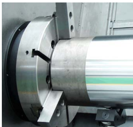
Заготовка зажата в трехкулачковом патроне
