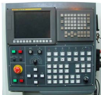
ЧПУ фанук и пульт управления токарного станка
